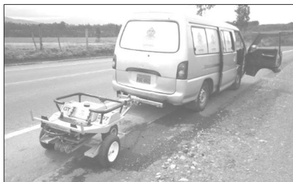
Figura 2: Medidor de Fricción tipo Fixed Slip
